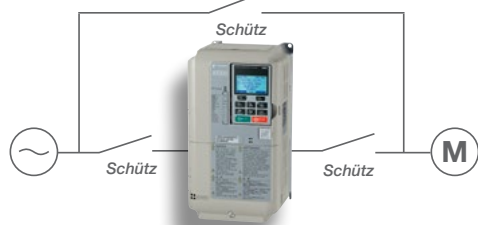
Standard-Frequenzumrichter Herkömmliche Frequenzumrichter erfordern externe Schütze, um den Antrieb zu „umgehen“
