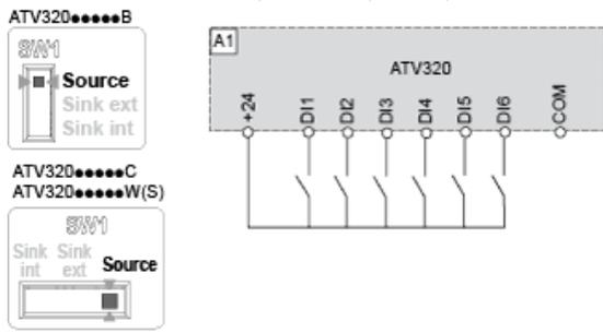
Schalter SW1 in Stellung „Quelle“ (Source) und Verwendung einer externen Versorgung für die Digitaleingänge.
