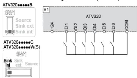
Schalter SW1 in Stellung „Senke ext.“ (Sink Ext.) und Verwendung einer externen Versorgung für die Digitaleingänge.
