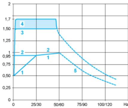
1 : Selbstkühlender Motor: Nützliche Dauerdrehzahl (1)
