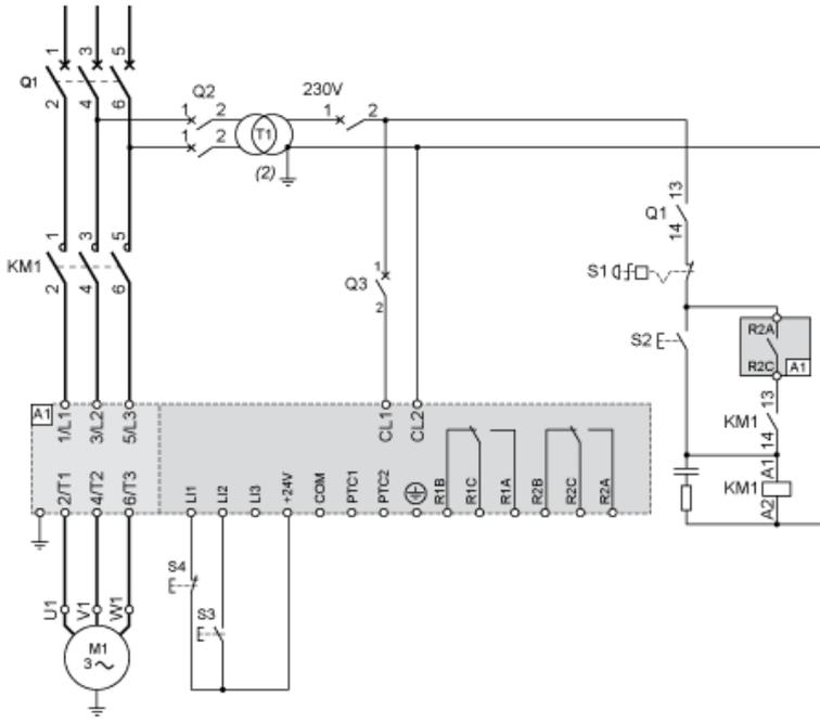
**Anschluss in die Dreieckwicklung des Motors, mit jeder einzelnen Wicklung in Reihe**
