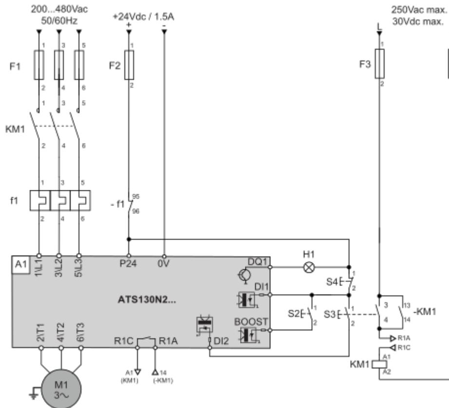
**HINWEIS:** Setzen Sie die
