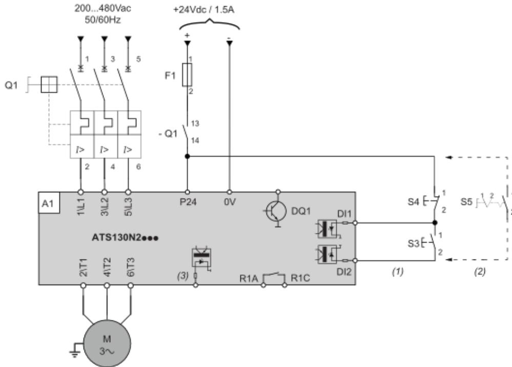
**HINWEIS:** Setzen Sie die
