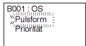
Die Option „Pulsform“ verfügt über zwei Timer, die eingestellt werden können. Der Timer „T“ gibt die Sollzeit für die Dauer des Ausgangssignals des OS-Funktionsblocks an. Der Timer „t“ gibt den Istwert der Sendedauer des Signals an. Wenn Sie für „t“ einen Wert eingeben, wird das erste Signal, das vom OS-Blockausgang gesendet wird, um den Wert „t“ verkürzt gesendet, da der Wert „t“ als bereits erfolgte Sendedauer gerechnet wird.
