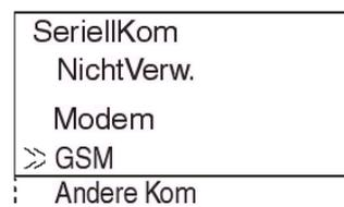
Aus dem Hauptmenü scrollen Sie herunter bis „Weitere/SeriellKom/GSM“. Nach dem Betätigen der „OK“-Taste sehen Sie das GSM-Menü.
